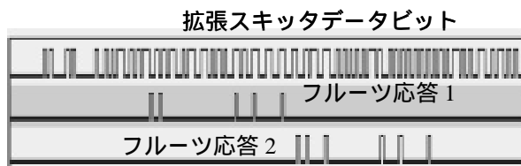
図10 試験3のパルス設定(空側5個重畳)
