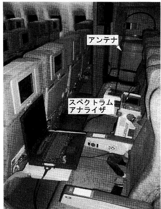
図1 機内の電波環境測定装置
