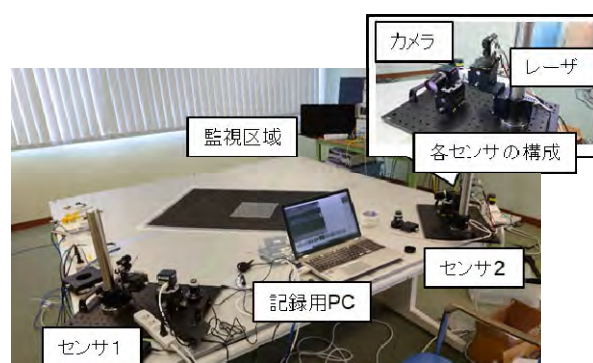
図1 滑走路模擬実験と各センサの配置
