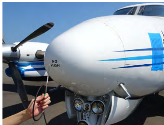
図2 ビーチクラフト B300 型機干渉経路損失測定状況
