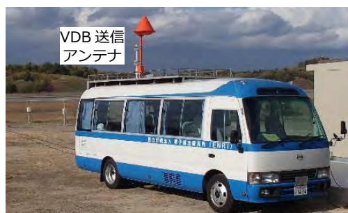
計測車両と VDB 送信アンテナ
