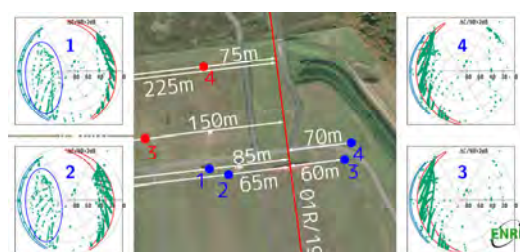
図1 新千歳空港GBASの基準局配置と離着陸機による影響（2dB 以上の変動箇所）
