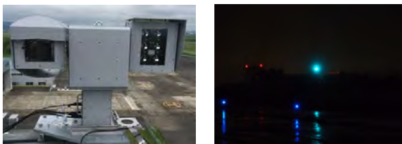
図4 PTZカメラに組み込まれたライトガン(左)と夜間ライトガン点灯試験の様子(右)
