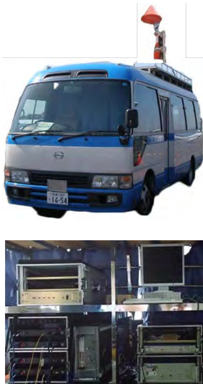
(上) 計測車両と VDB 送信アンテナ (下) GBAS 機器
