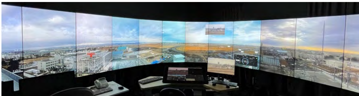
図1 360° 表示のプロトタイプシステム
