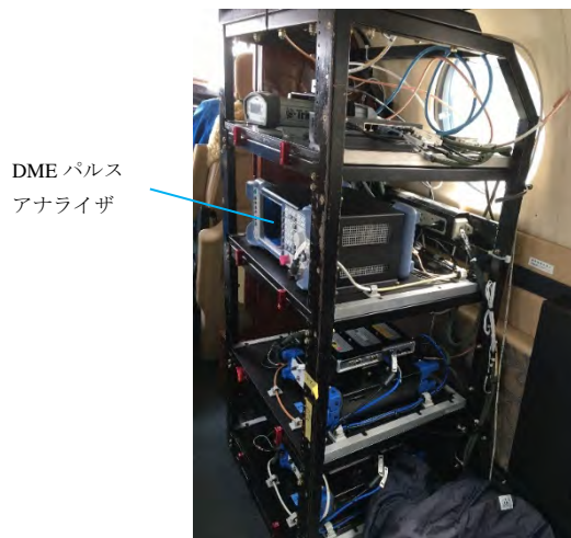
(a) EDS300 の実験用航空機への搭載
