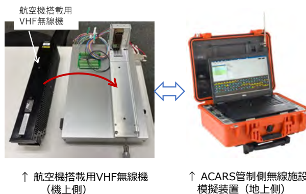
図3 実験用VHF無線機システム
