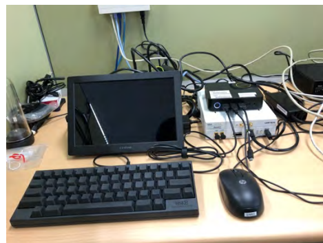
図 1. 開発中の VHF シンチレーション受信機。USRP N210 (右下)、制御 PC (右上)。
