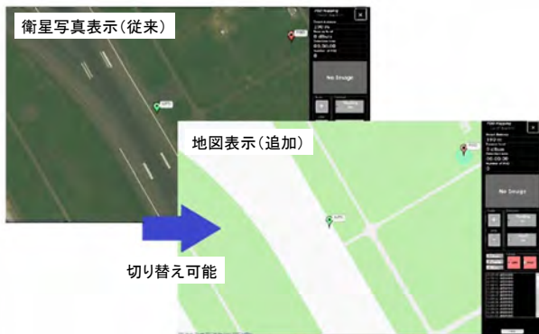
図3. 異物回収端末 UI への地図表示切り替え機能の追加
