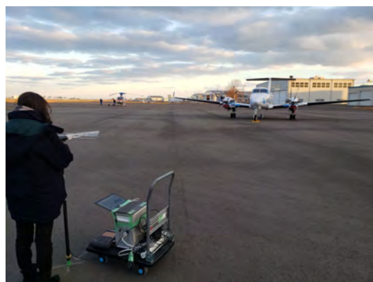
図2. ビーチクラフト B300 型機 放射電磁界測定状況
