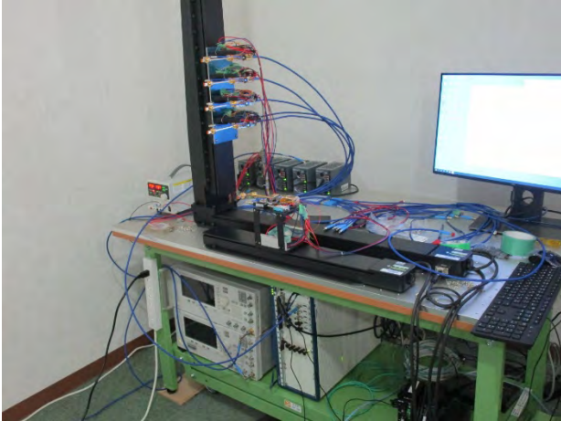
図2 4ch 並列電波イメージャの外観
