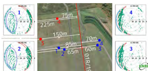
図1：新千歳空港 GBAS の基準局配置と離着陸機による影響 (2dB 以上の変動箇所)
