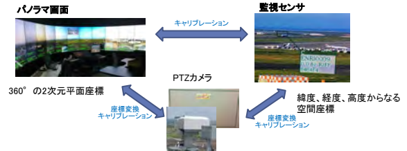
図 3 監視センサ情報の活用ためのシステムキャリブレーションの概要
