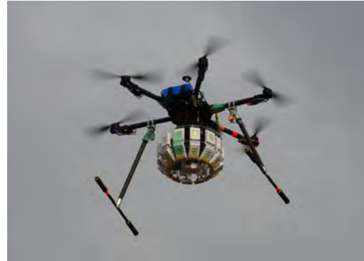
図1. 全周監視基本機能確認モデルを用いた試験 (実験用ドローンを用いた飛行試験)
