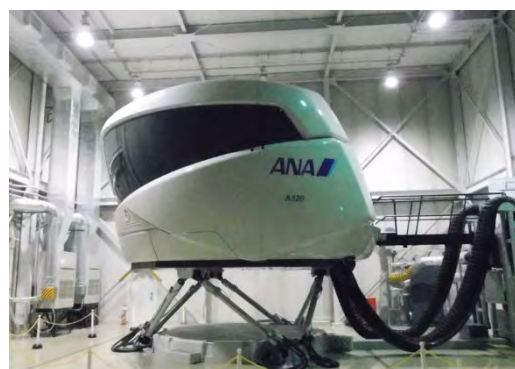
図 1：フライトシミュレータによる検証実験
