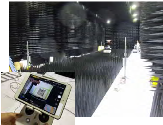
図 2 DJI 社製ドローンの位置推定実験の様子
