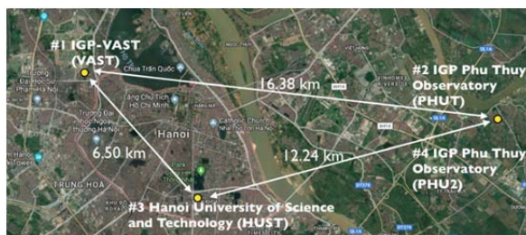
図 1 GNSS 受信機の配置
