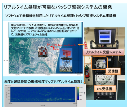
図 1：開発したリアルタイム処理パッシブ監視システムと実験環境
