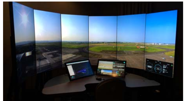
図2 制御室側の評価システム(ディスプレイ及び操作作用HMI)
