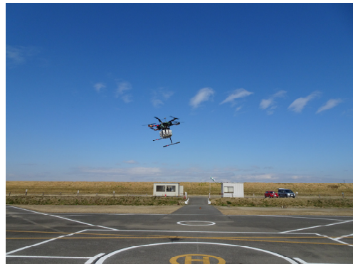
図7. 無人航空機を用いたヘリコプタ全周監視支援システムの基礎実験状況
