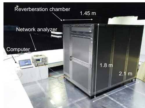
図2. 電磁界特性評価のためのリバレーションチャンバを用いた測定系概観
