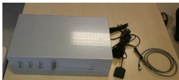
図 2 製作した PSSR 局外観
