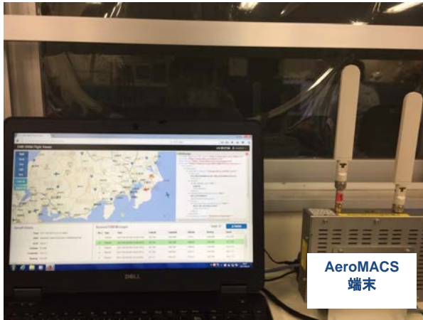
図2 AeroMACSプロトタイプと実験用SWIMシステムの接続によるSWIM情報の表示例 (PC画面表示：飛行情報交換メッセージ)
