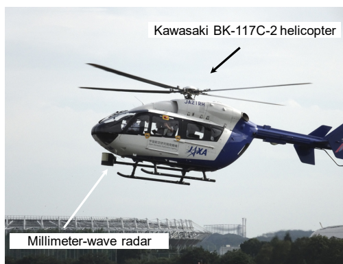
図2. 76 GHz 帯前方障害物探知ミリ波レーダの飛行試験用ヘリコプタへの搭載状況
