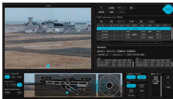
図4 操作用 HMI デザイン例（カメラ操作機能及び、フライトプラン、気象情報の設定を統合した例）
