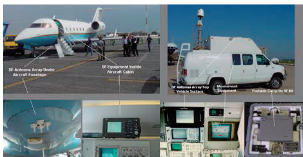
図2 米国の空域においてRFIが原因と思われるGPS受信異常が多く報告。上空から干渉源の範囲を絞りその後ポータブル装置で発生箇所を特定(出典:FAA)。
