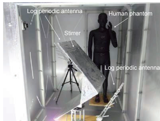
図1. 負荷装加リバブレーションチャンバの内部状況
