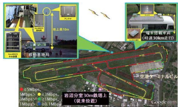
図1 仙台空港におけるアンテナ配置最適環境下でのAeroMACSプロトタイプの性能評価実験結果
