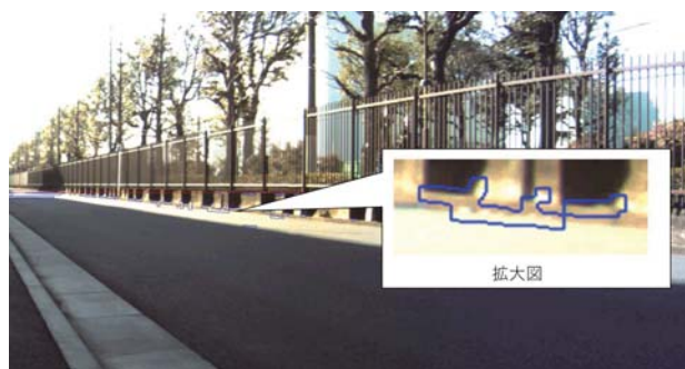
テストサンプルを置いた場合の標準状態から 変化した部分の抽出画像の例
