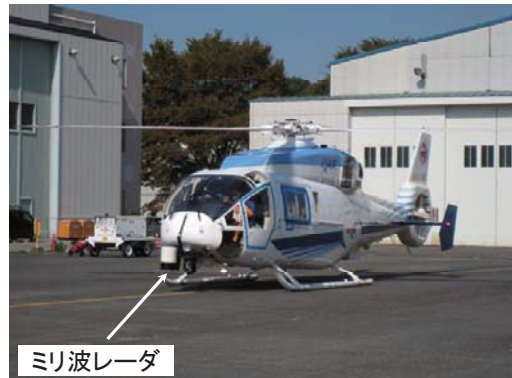
図1. 実機ヘリコプタ搭載状況
