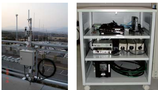
図2. ADS-B受信システム (高松空港事務所)
