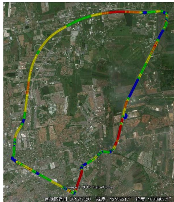
図2 バンコクにおける走行軌跡 （赤～青）位置誤差の大きさを表し、赤は誤差が大きく、青色は誤差が小さい
