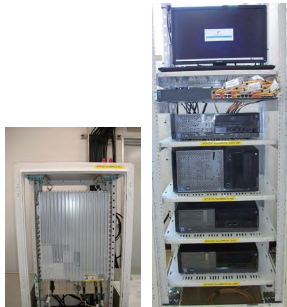
図1 開発したAeroMACSプロトタイプ基地局(左)とAeroMACSプロトタイプサーバ類(右)
