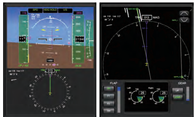
図4：反力付きシミュレータの表示画面 (左)プライマリーフライトディスプレイ、(右)ナビゲーションディスプレイ
