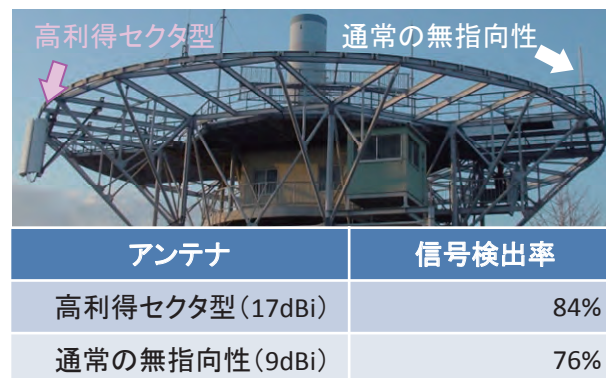
図5 両アンテナの設置状況と信号検出率の比較
