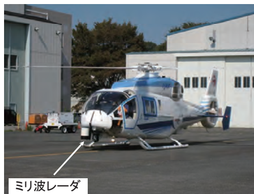
図1 実機ヘリコプタ搭載状況
