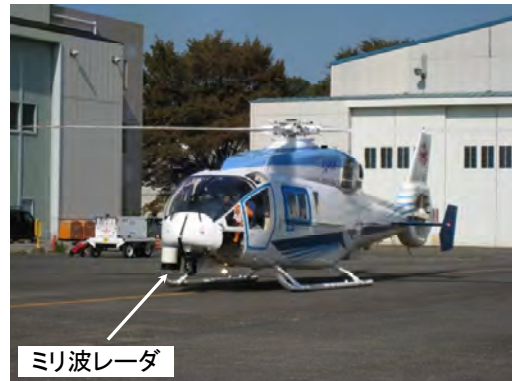
図1 実機ヘリコプタ搭載状況
