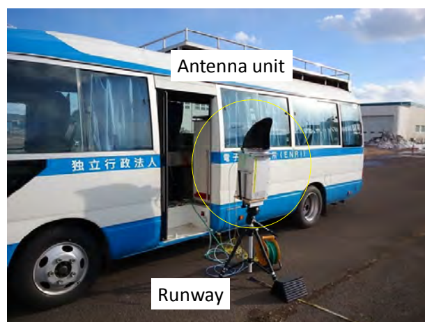
光ファイバー接続型ミリ波レーダーの屋外試験
