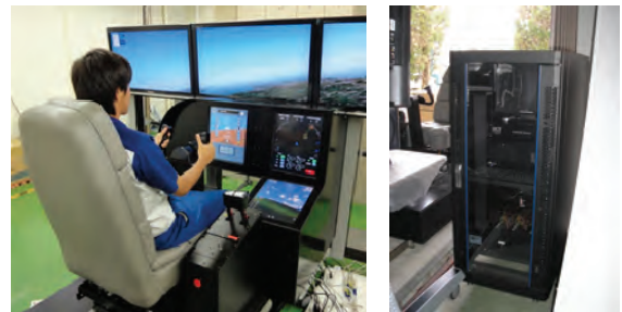
図5 反力付きシミュレータ装置 (左: 操縦イメージ、右: 反力生成装置)
