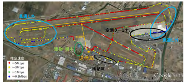
図1 AeroMACS信号実験システムから推定される伝送速度(出力1W)
