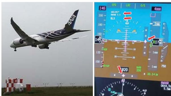
図 2: 関西国際空港での B-787 による GBAS 進入実験時の様子(左図)とコックピット計器の表示例(右図)
