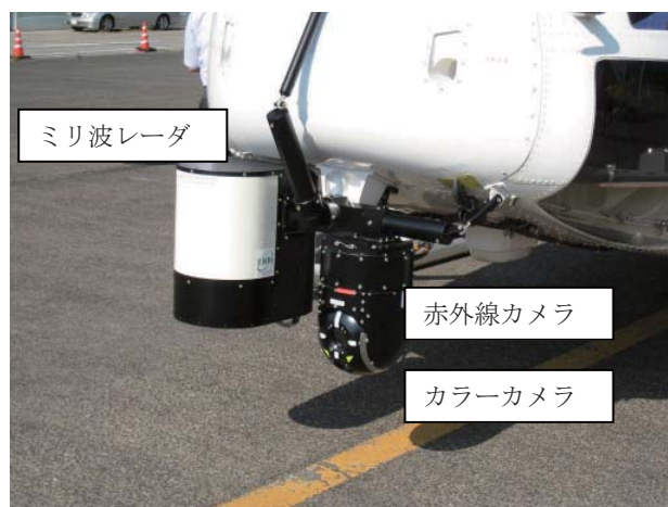
センサー部取り付け状況
