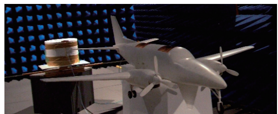
図1 電波無響室における電波伝搬実験の様相
