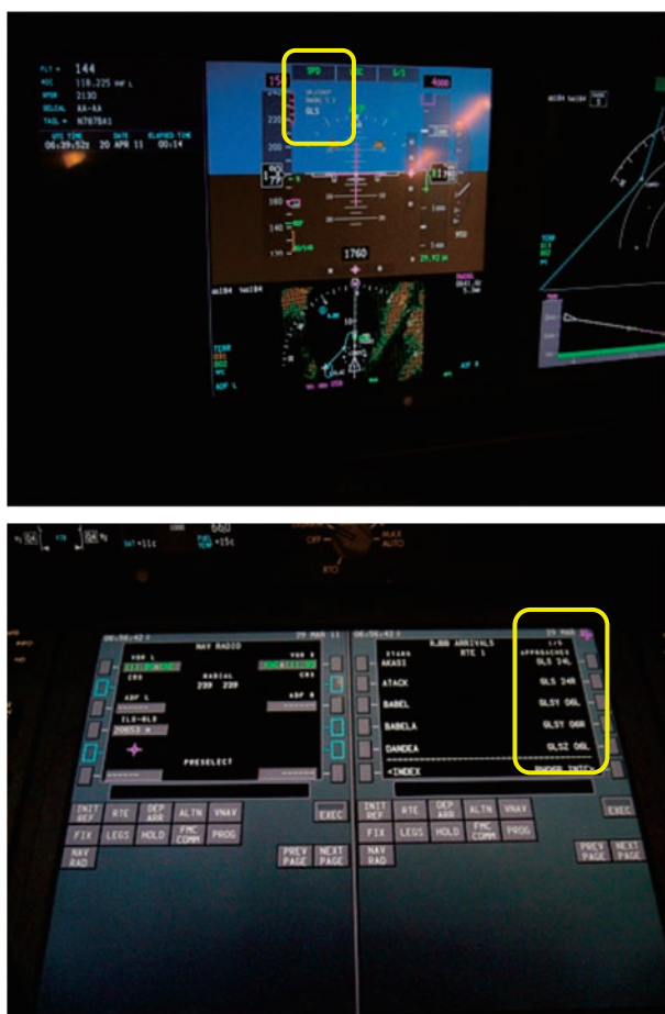
図 2 B787 飛行シミュレータに関空 GBAS プロトタイプに関する環境を模擬した画面
