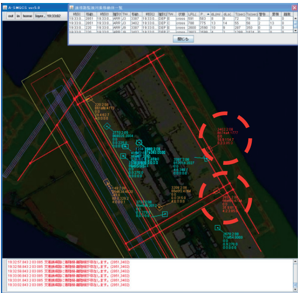
図3 主要誘導路における2機間のコンフリクト注意喚起画面の例(円で囲んだ2機に対する検出)
