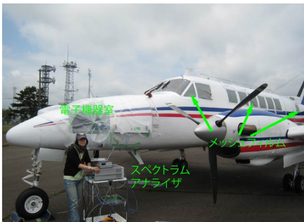
B-99 における経路損失測定状況 (受信側)
