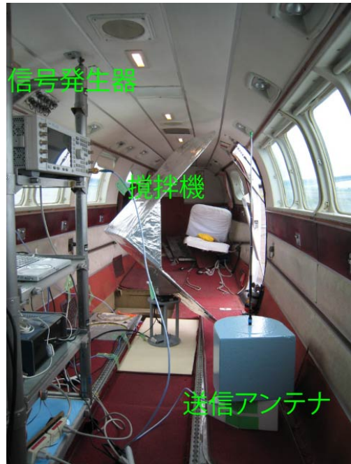
B-99 客室内における送信アンテナ設置状況
