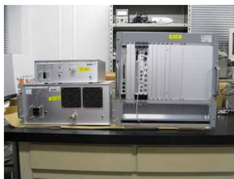
図1: 試作した信号生成装置(右)、高周波増幅部(左下)、干渉防止装置(左上)
