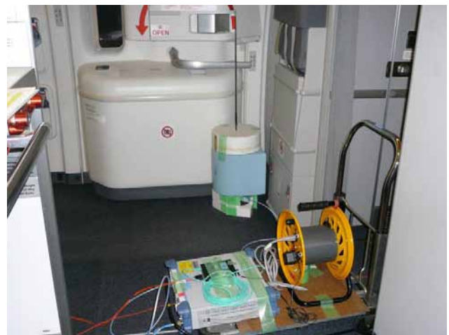
B-777 旅客機における試験電波放射状況
