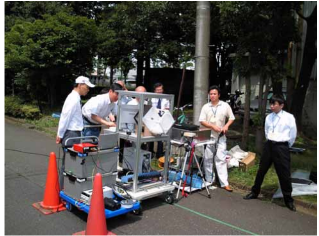
3種のミリ波レーダによる干渉評価実験
