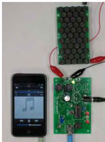
図 1: 実験システム送信部。上の基板はパラメトリックスピーカ本体、下の基板は駆動部、左側は携帯型オーディオプレーヤ
