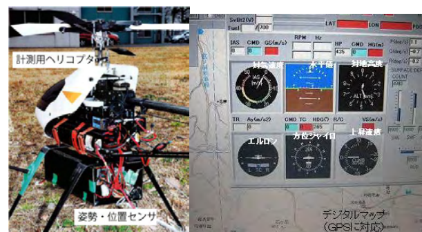
(a)ヘリコプタとセンサ (b)計器模擬装置の表示例 システム評価用ヘリコプタと計器システム
