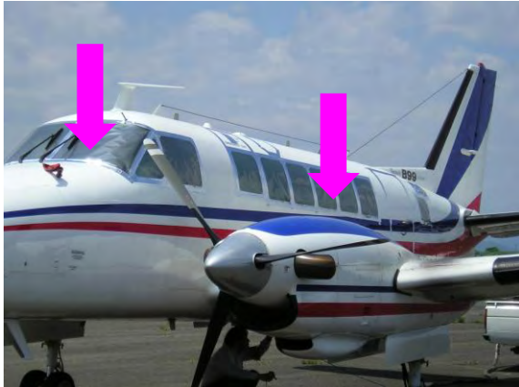
(c) 実験用航空機 B99 に貼付した電波遮蔽材
