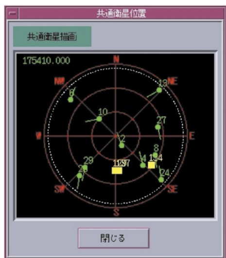
図1 GBASデータ処理装置における衛星配置の表示例(黄色はSBAS衛星を、緑色はGPS衛星を、番号はそれぞれの衛星番号を示す)
