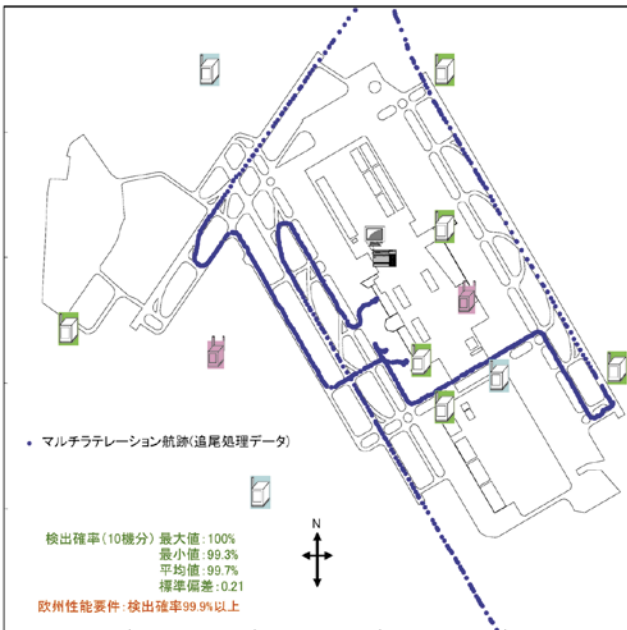
図3 エアライン機評価の追尾処理データ航跡記録例と検出率
