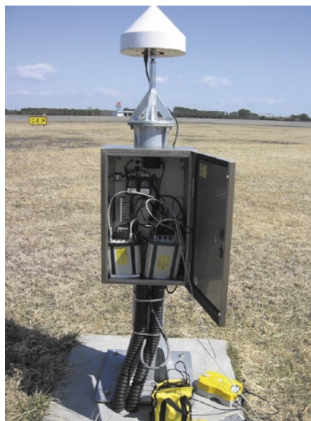
図1 GBASテストベッド（仙台空港内の基準局）での実験準備の状況
