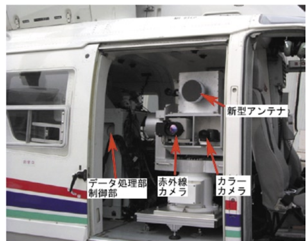
図4 ヘリコプタ上の障害物探知・衝突警報システム
