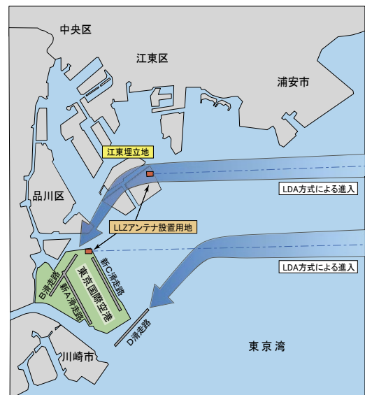
図1 LDA方式による平行進入概念図
