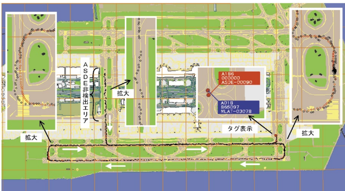
図6 飛行検査機による航跡記録例 (C滑走路側)
