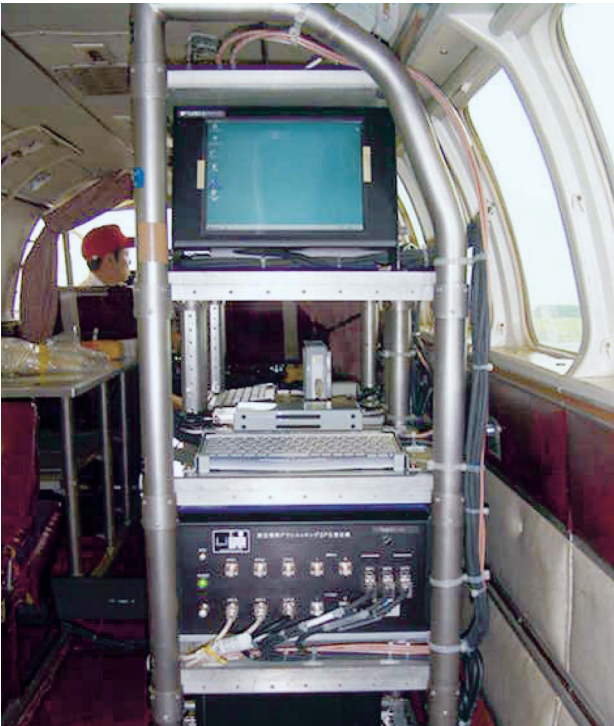
図1：航空機用ダウンルッキング GPS 受信機の航空機搭載図
