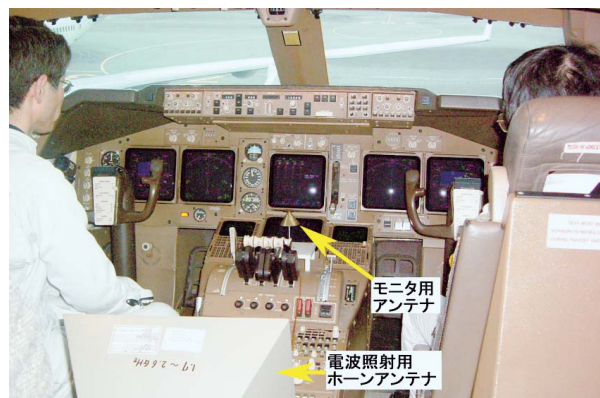
図3 機内表示装置に対するイミュニティ試験
