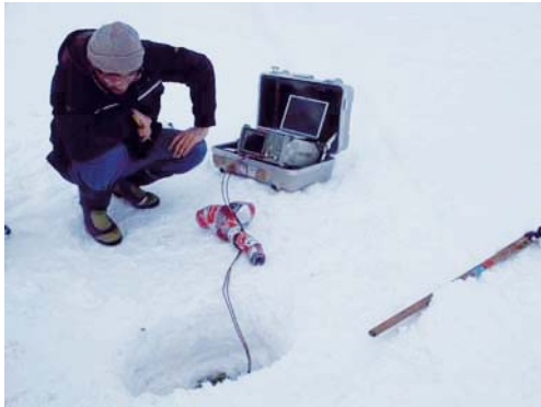
図1 GP 反射面の雪の誘電率測定
