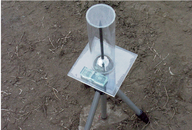
図1 試作した全方位光学センサ
